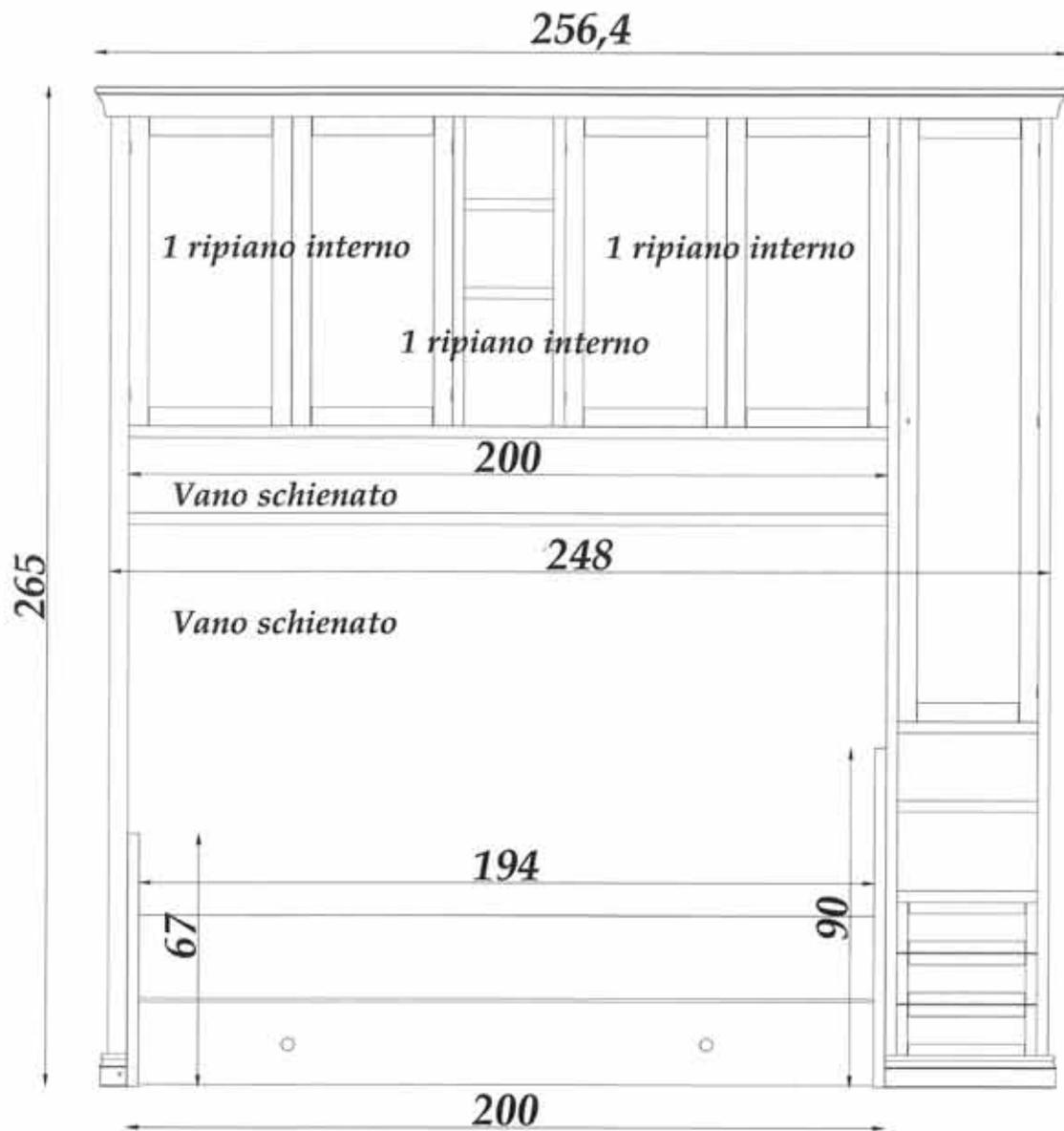
*Ponte Letto in LISTELLARE TOULUPIER DA 17 mm con spalle applicate da 30 e 50 mm;*
